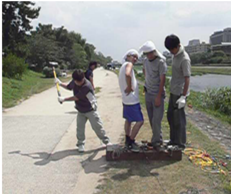
図 4.11: 板たたきによる人工地表震源
